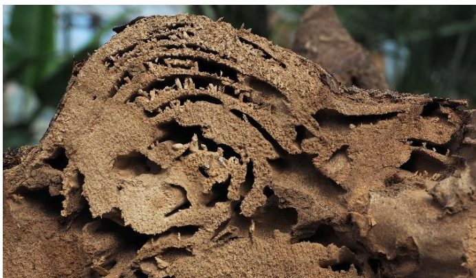
Figuur 4: Aantasting van voorjaarshout door de Amerikaanse grondtermiet ( Reticulitermes flavipes ). Bron foto: Jinze Noordijk.
