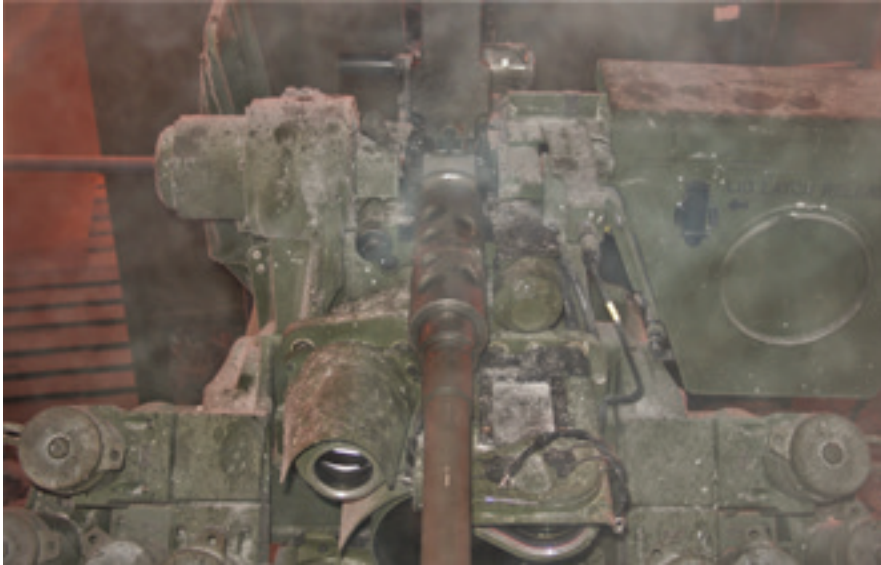
Een dynamische beproeving van een remote controlled weapon station in de klimaatkamer bij een temperatuur van -30 graden Celsius.
